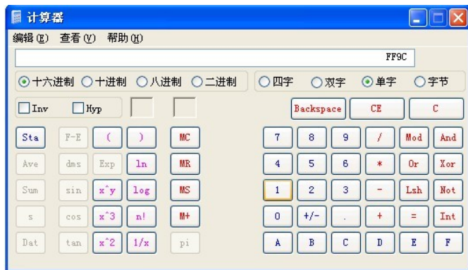
图 10.4 “-100”转换为 short 型并以十六进制显示
