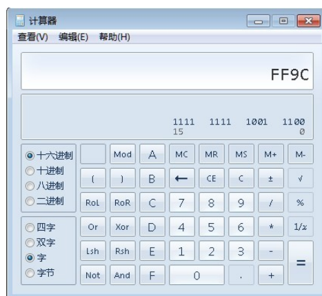
图 10.8 “-100”转换为 short 型并以十六进制显示
