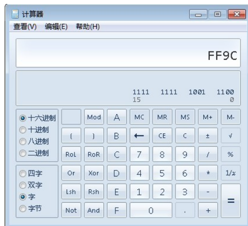
图 10.8 “-100”转换为 short 型并以十六进制显示
