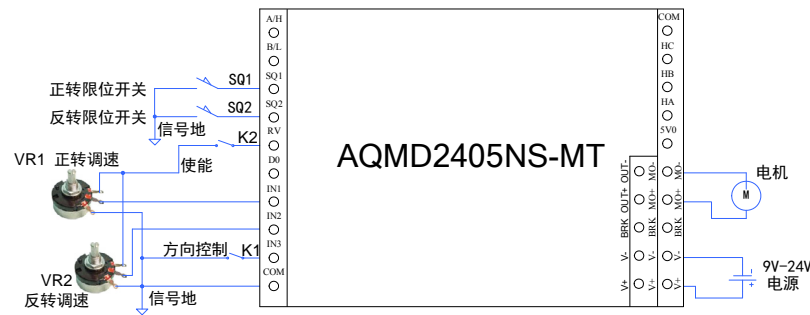
图 5.47 双电位器自测速闭环调速方式的接线图
