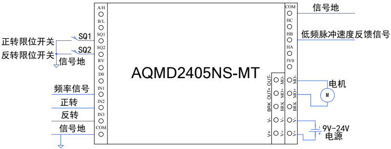
图 5.78 频率信号外接低频脉冲反馈信号闭环调速方式接线图
