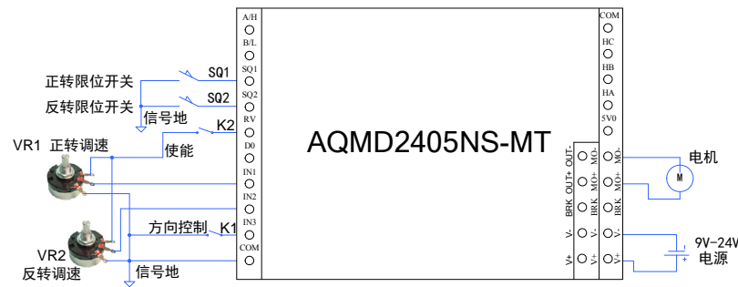
图 5.13 双电位器占空比调速方式的接线示意图
