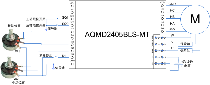
图 4.7 双电位器位置协同控制的接法
