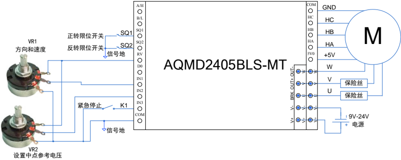
图 4.6 双电位器协同调速的接法
