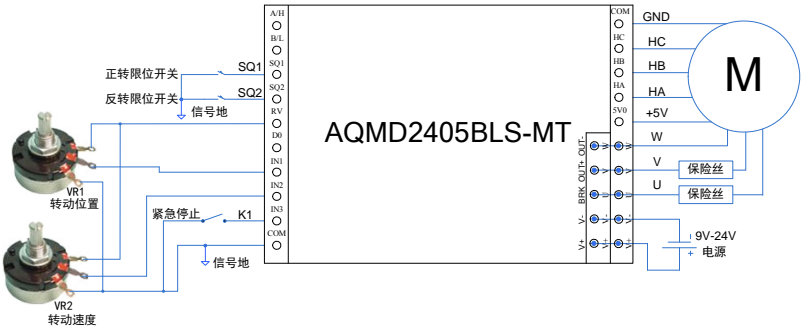
图 4.5 双电位器位置独立控制的接法
