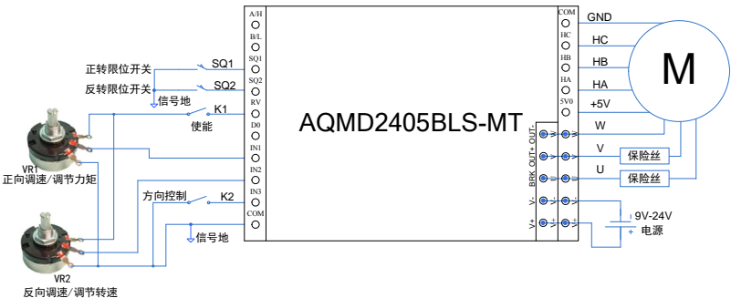
图 4.4 双电位器独立调速的接法
